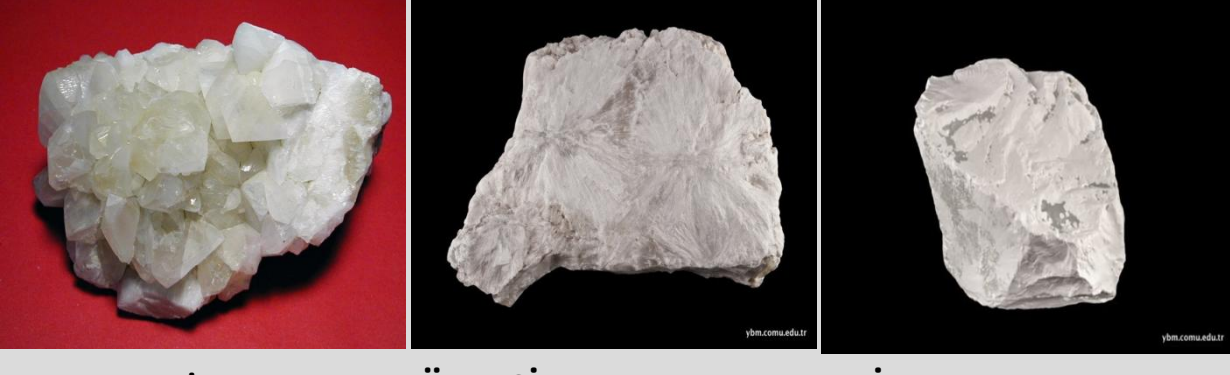
KOLEMANİT (CaB 3 O 4 (OH)3·H 2 O) ÜLEKSİT (NaCaB 5 O 9 .8H 2 O) TİNKAL (Na 2 B 4 O 7 .10H 2 O)
